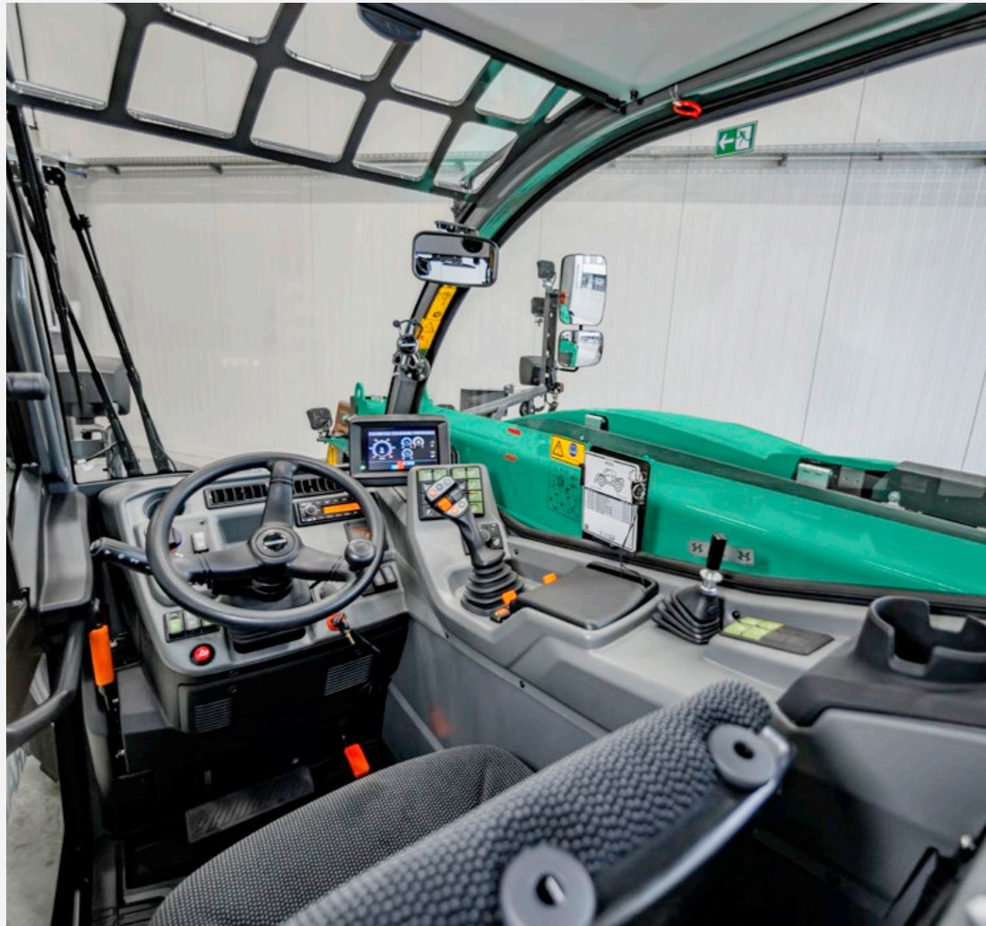
Goed zicht naar rechts dankzij de grote rechte ruit en de laag gepositioneerde telescooparm.
