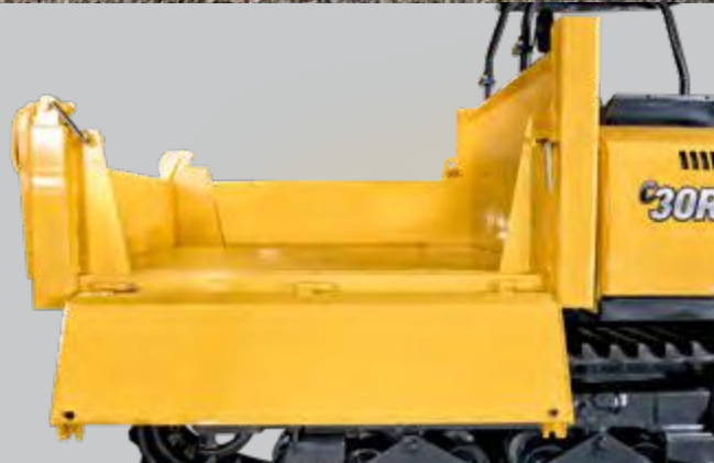
Wagen met kleppen aan drie zijden, storten aan achterzijde
