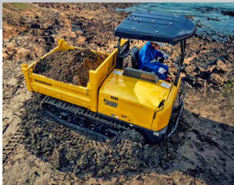
Draaien door beide rupsen om te keren
