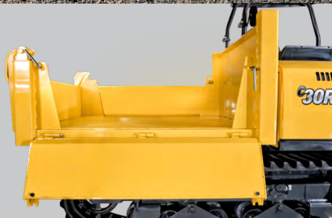
Wagen met kleppen aan drie zijden, storten aan achterzijde
