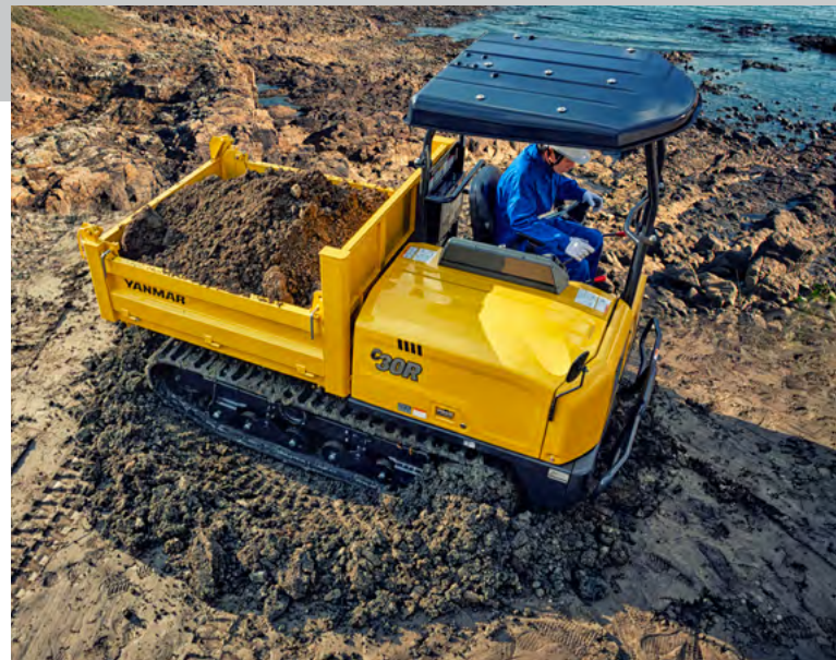
Draaien door beide rupsen om te keren
